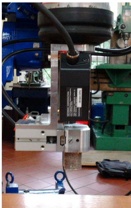
Rys. 8. Chwytnik robota przemysłowego MOTOMAN UP6 z zamocowanym laserem pomiarowym
