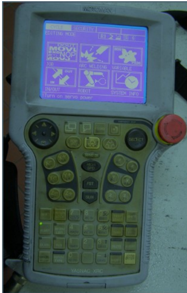
Rys. 3. Panel operatorski robota przemysłowego YASKAWA MOTOMAN UP6
