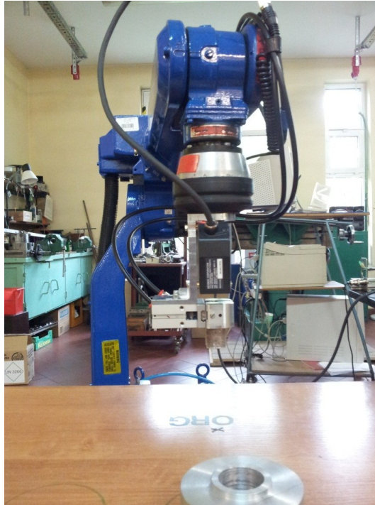
Rys. 4. Stanowisko doświadczalne robota przemysłowego YASKAWA MOTOMAN UP6.
