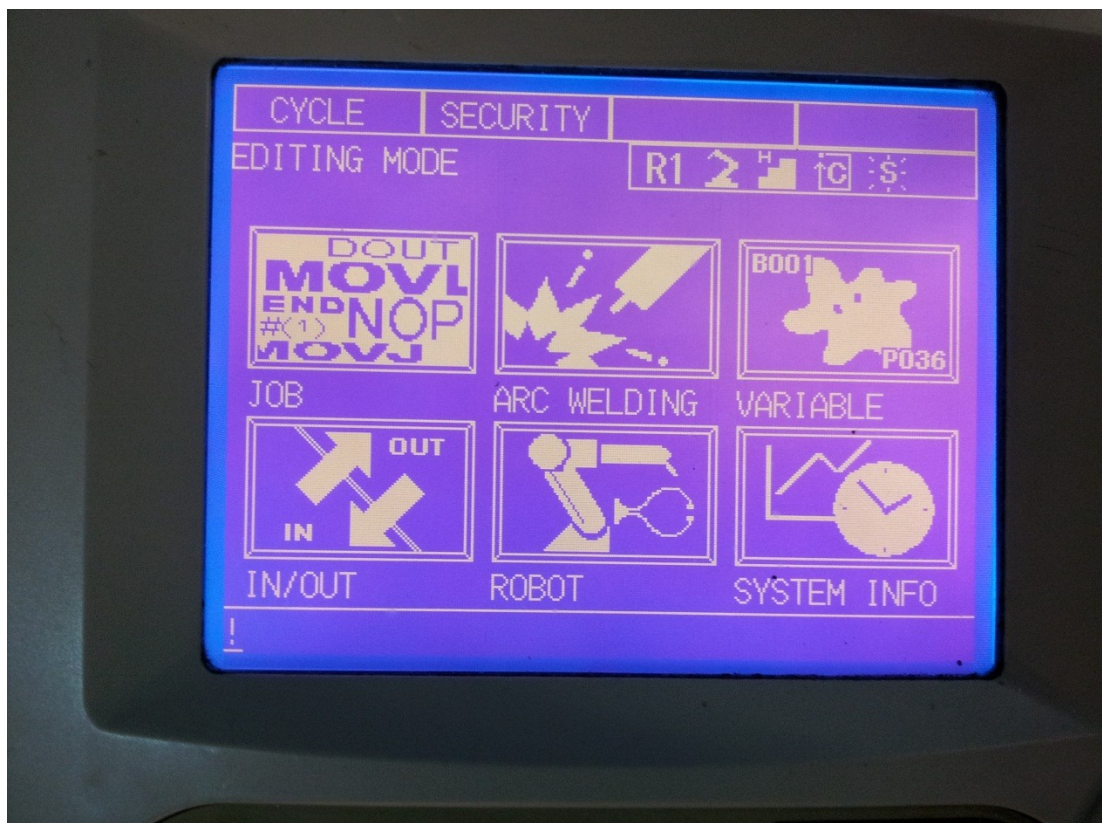
Rys. 6. Ekran panelu operatorskiego i wybór funkcji.
